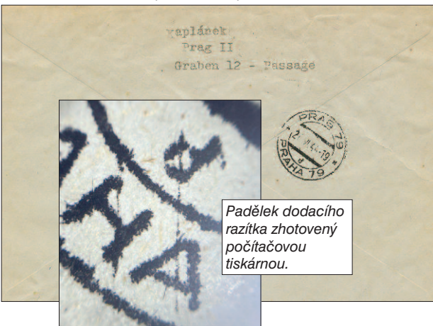
Vlevo detail (PRAHA 1) z pravého razítka, vpravo stejný detail z razítka padělaného počítačovou tiskárnou.
